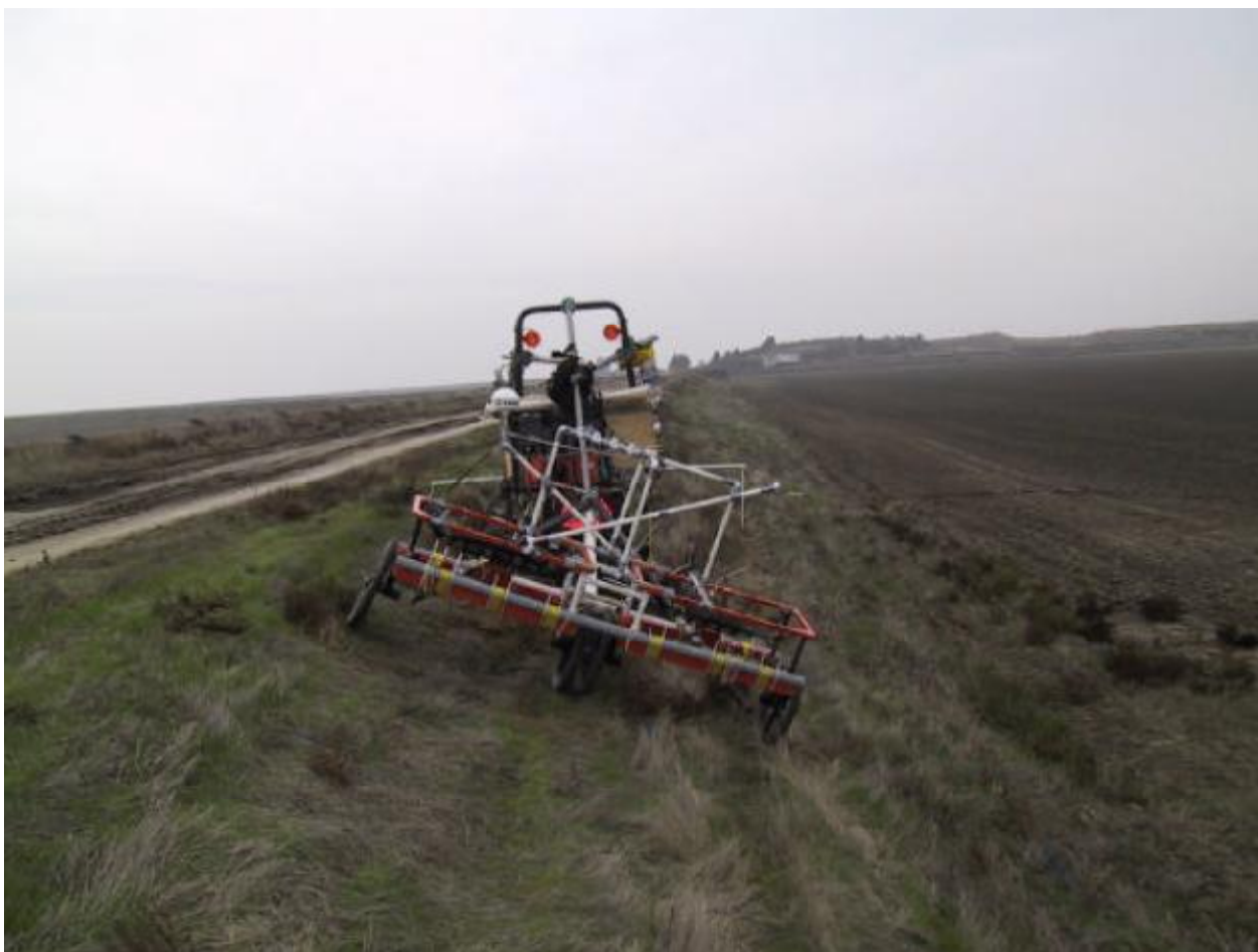
Рисунок 2: Двухэлементная установка (с двумя датчиками) металлодетекторов EM61-MK2, буксируемая по откосу бермы газонокосилкой с шарнирно-сочлененной рамой.
