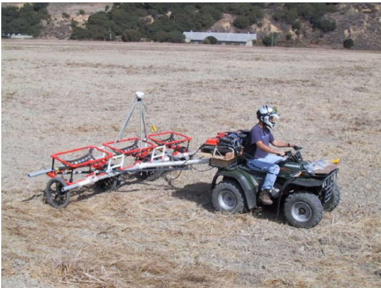
Рисунок 1: Установка, состоящая из нескольких металлодетекторов EM61-MK2 (с тремя датчиками), буксируемая транспортным средством повышенной проходимости.
