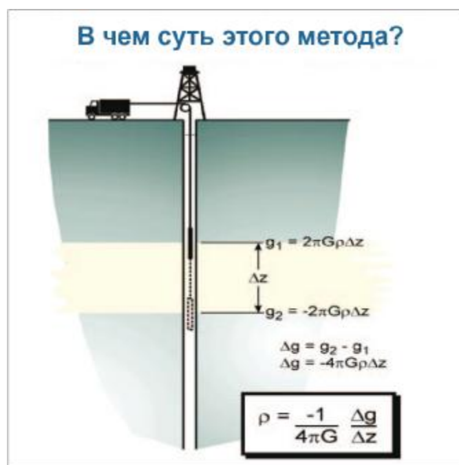
Рис. 8. Определение объемной плотности с помощью скважинных гравиметрических измерений
