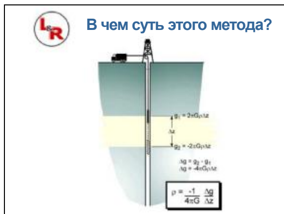
Рисунок 9: Определение объемной плотности с помощью скважинных гравиметрических измерений
